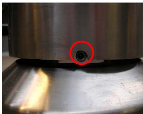
**Рис. 11** Стопорный винт против снятия (шестигранный Imbus SW4)
