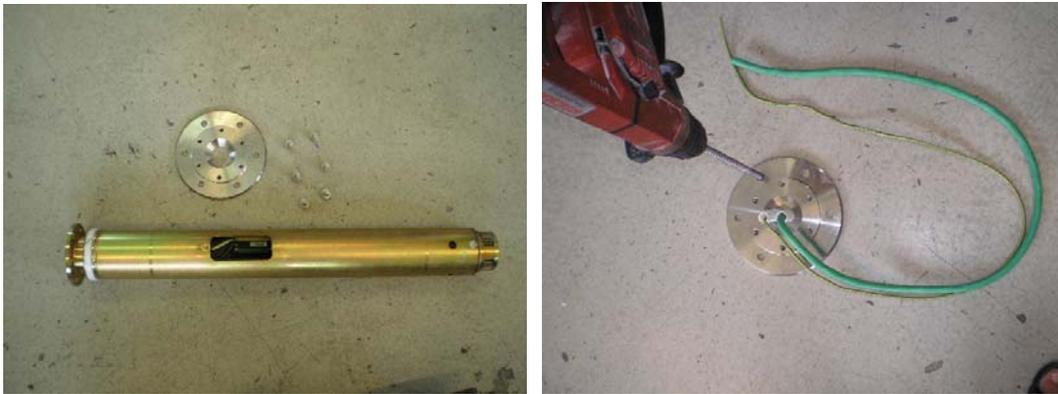
Шаг 6: Протяните 12-жильный кабель через корпус привода и вытяните его в ревизионное окно.
