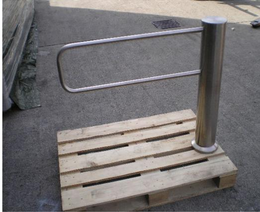
На месте установки должен быть готов законченный пол, на который турникет будет крепиться анкерами. В случае установки на незаконченный пол на стяжке должна быть установлена напольная консоль. Соединительный кабель (зеленый кабель привода) должен быть подведен и иметь запас от пола не менее 1 м.
