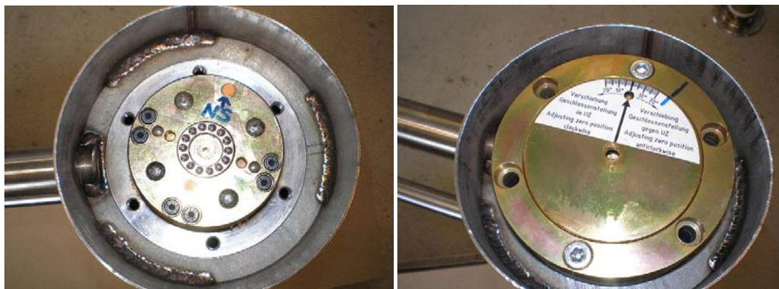
Закрутите стопорный винт в нижней части турникета с помощью шестигранного ключа SW4
