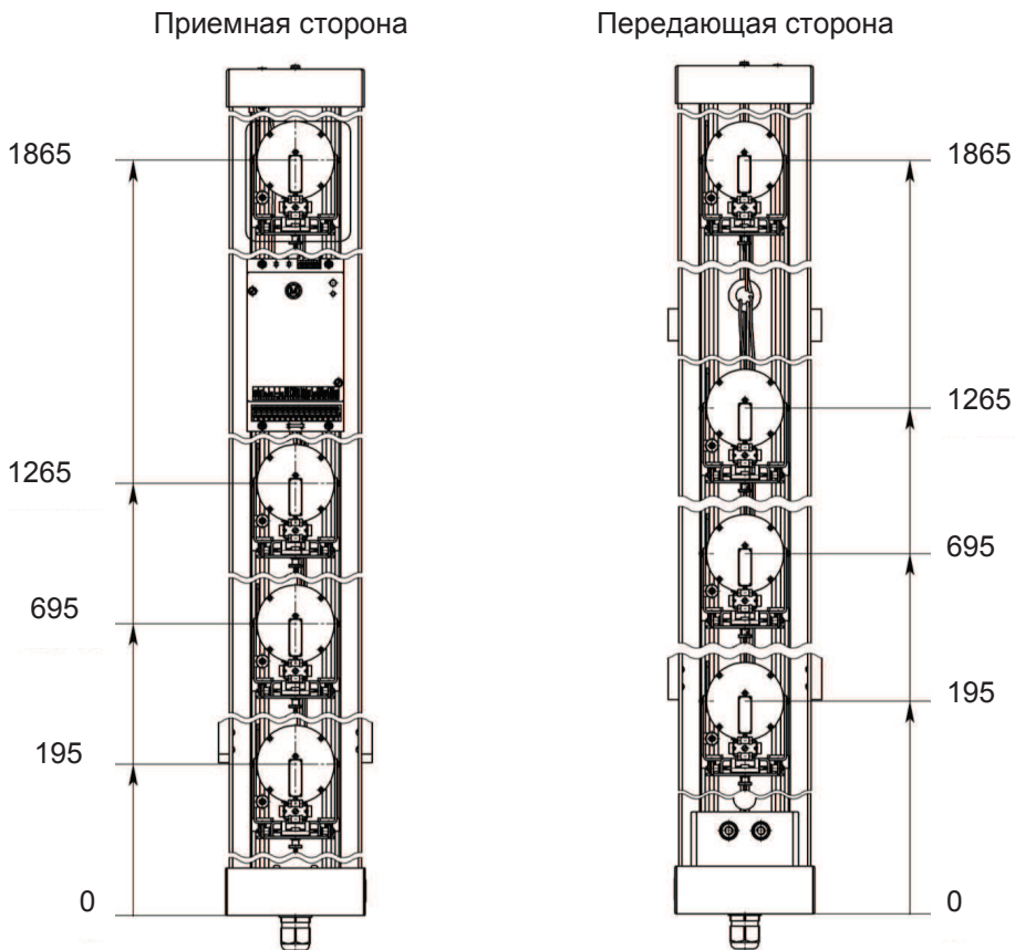
Рисунок 2.17 – Башня ПРМ-ПРД БАЖК.301317.011 (башня ПРМ-ПРД БАЖК.301317.023) со снятыми защитными кожухами из поликарбоната
