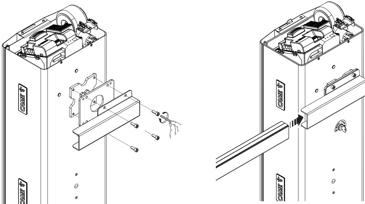
Затяните винты динамометрическим ключом с крутящим моментом 20 Нм.
