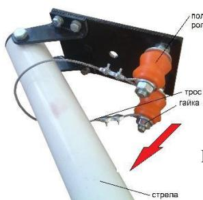
При наезде на стрелу в закрытом положении она выскакивает из полиуретановых роликов и откидывается см. Рисунок 10.
