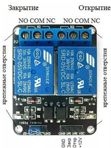
Стороннее оборудование подключается к клеммам реле открытого и закрытого положения в соответствии с требованиями оборудования. МСК подключается к плате «Цифра-1М» к разъему X18 и устанавливается с помощью дистанционных стоек через крепежные отверстия (см. Рисунок 9).
