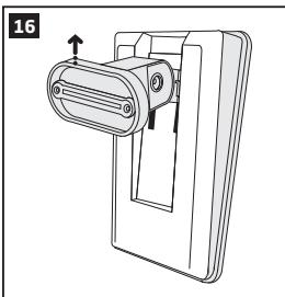
**ВНИМАНИЕ:** Убедитесь в том, что держатель надежно закреплен в устройстве, в противном случае задняя кнопка тампера не сможет корректно функционировать. Если не собираетесь использовать заднюю кнопку тампера, пожалуйста отключите ее, установив перемычку на контакты DIS-TAMP2 (см. раздел 2.2 Назначение Контактов и Светодиодов LED для более подробной информации).
