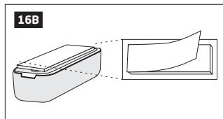
8. Вывните пластиковую пластину находящуюся между одним из контактов и слотом для батарей EWD2.
