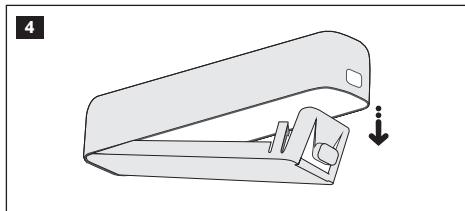
2. Вывните печатную плату (PCB) из корпуса устройства.
