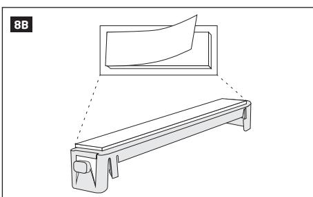
**ВНИМАНИЕ:** При использовании данного метода крепления (рис. №. 8В), кнопка тампера в задней части корпуса НЕ будет работать.
