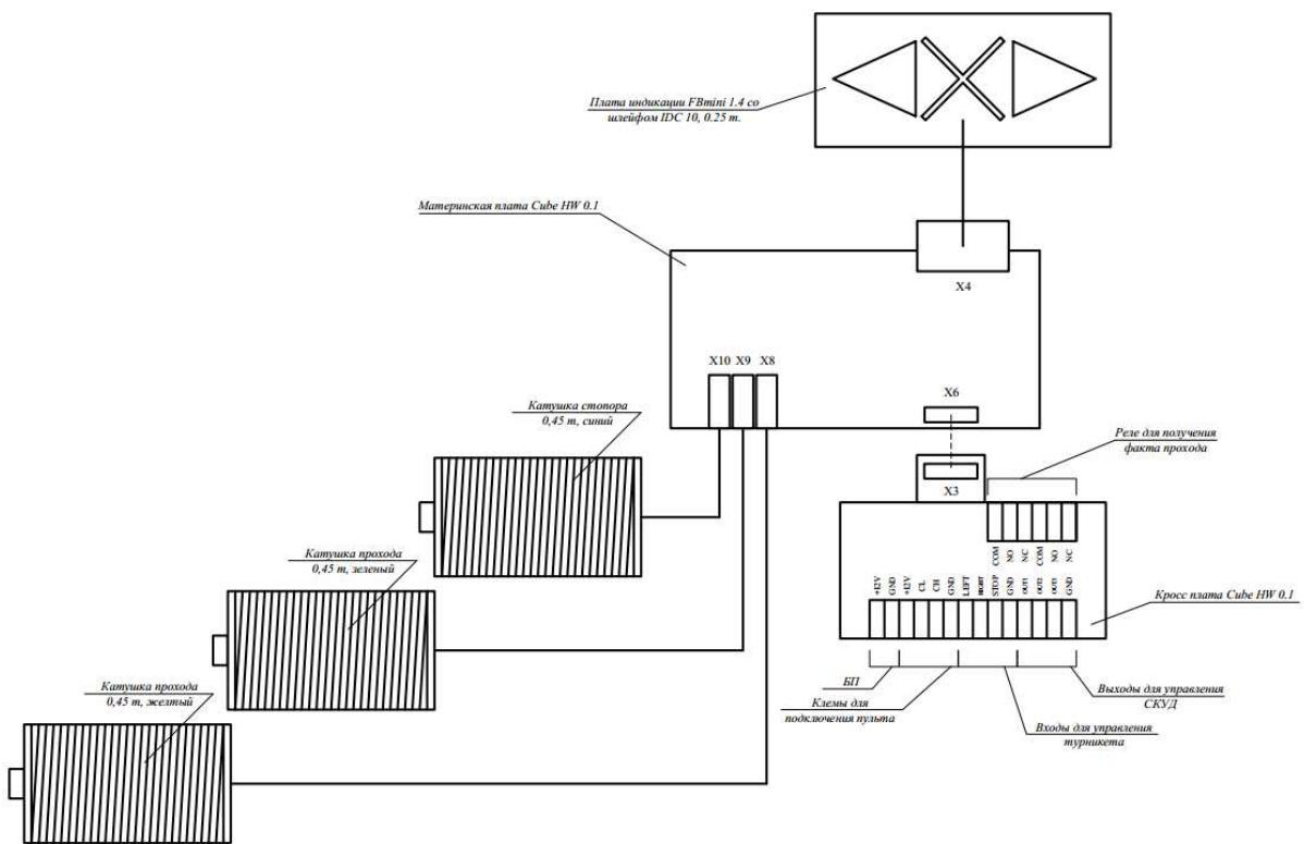
*Рис. 6. Схема турникета и схема его подключения*
