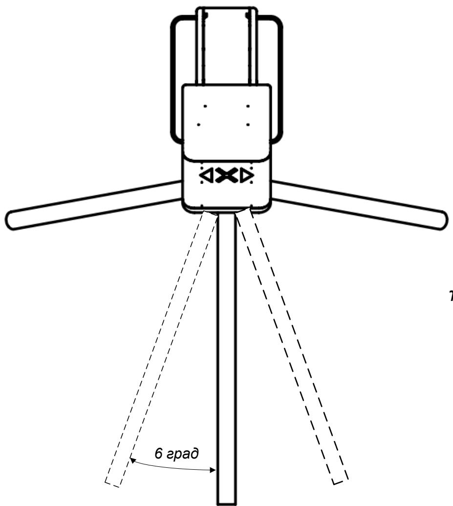
Рис. 3. Возможный свободный ход планки в режиме «STOP»
