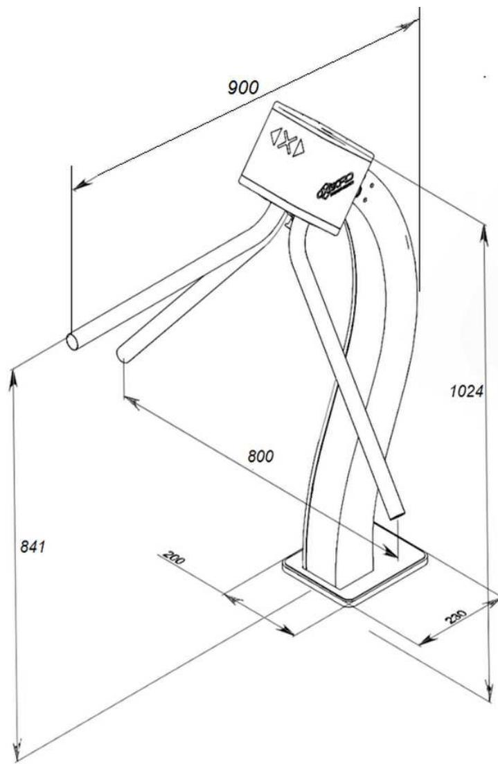
*Рис. 1. Общий вид и габаритные размеры турникета*
