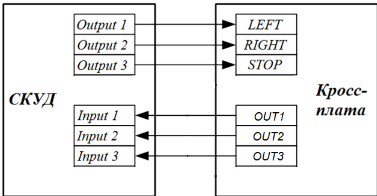
Рис. 15. Схема подключения пульта управления к контроллеру СКУД
