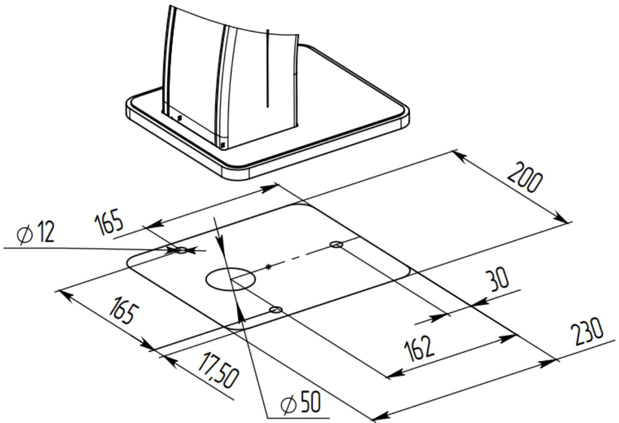
*Рис. 16. Расположение монтажных отверстий и габариты турникета*
