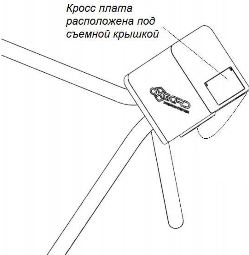
*Рис. 9. Расположение кросс-платы на стойке турникета*
