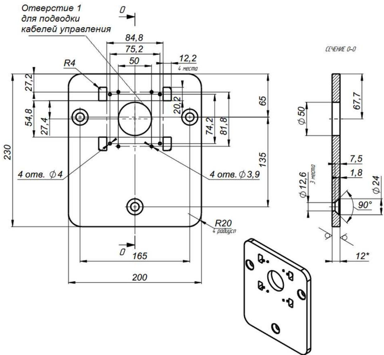
Рис. 6. . Установочные размеры ( дан чертеж нижней опоры турникета)
