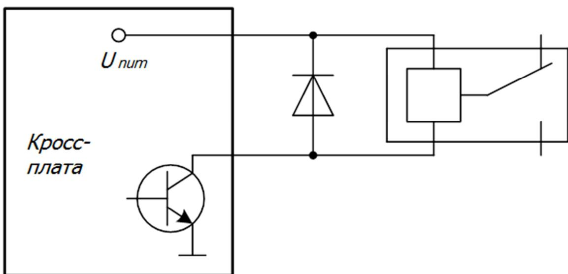
*Рис. 14. Схема подключения диода параллельно обмотке реле*
