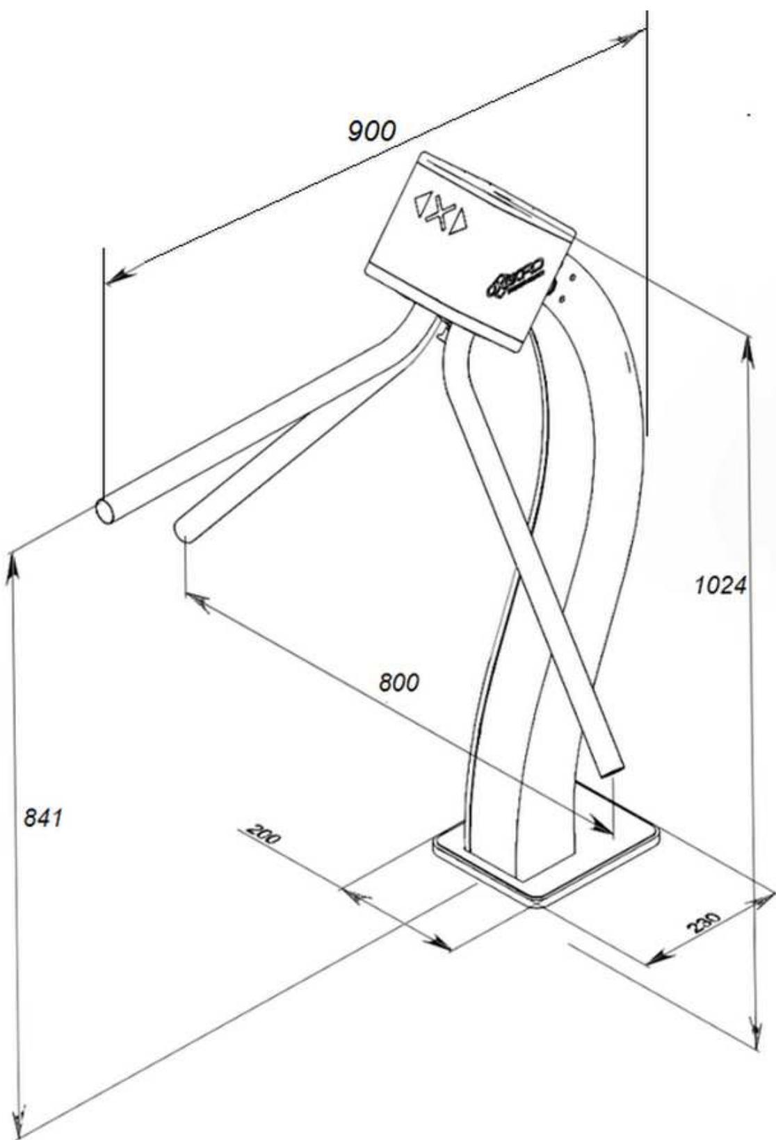
Рис. 1. Общий вид и габаритные размеры турникета
