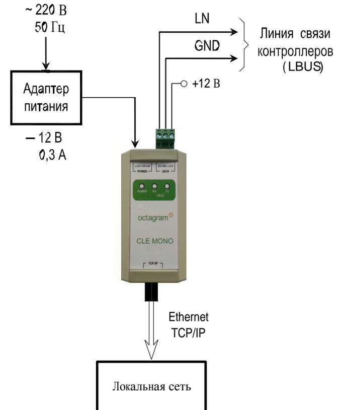
Рис.1. Схема подключения конвертера CLEM
