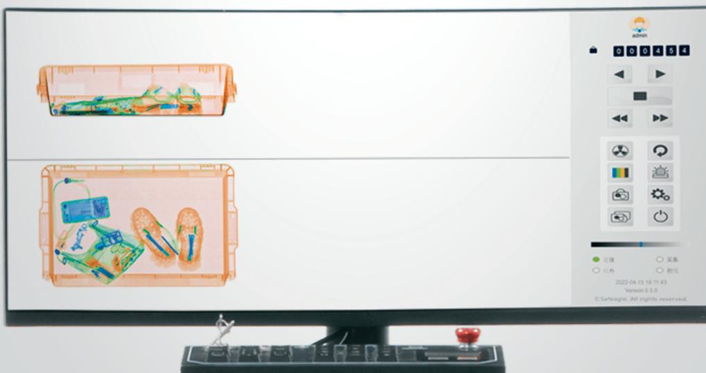
Две проекции на одном мониторе. Возможность переключения режимов отображения сканирований на мониторе в горизонтальной или вертикальной развертке
