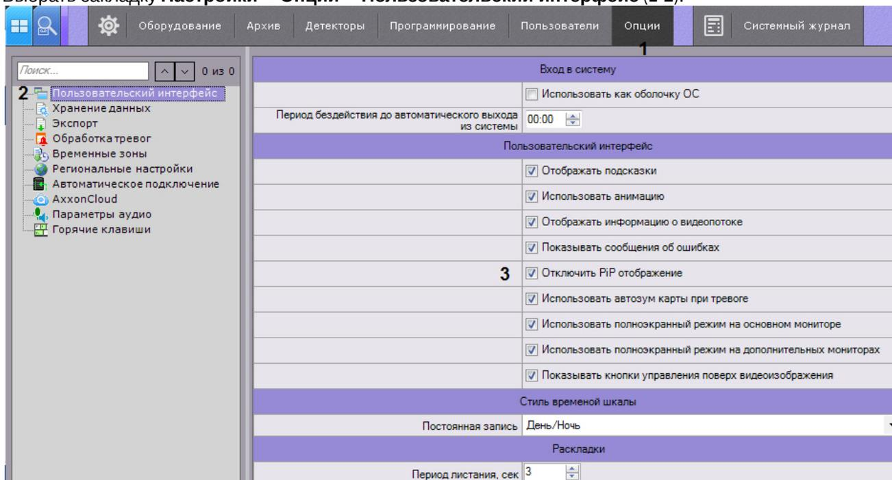
2. Установить флажок **Отключить PiP отображение (3)**.
