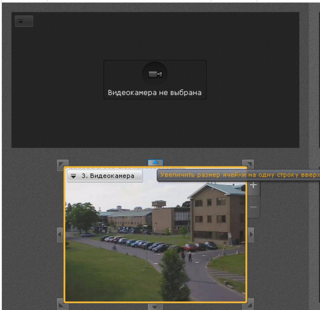
Также существует возможность произвольного изменения размера выделенной ячейки. Для этого следует нажать кнопку на границе ячейки и растянуть или сжать ячейку до требуемого размера. Изменение размеров ячейки осуществляется только в одном направлении. Растягивание или сжатие ячейки в двух направлениях с помощью угловых кнопок не производится. Увеличение (уменьшение) размера одной ячейки происходит вместе с одновременным уменьшением (увеличением) размера соответствующих соседних ячеек.
