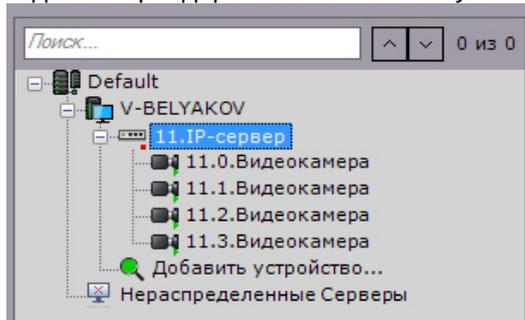
Настройку каналов IP-сервера необходимо производить отдельно для каждого задействованного канала (с помощью дочерних объектов **Видеокамера**).
