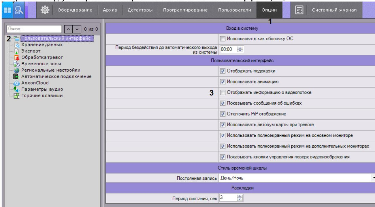
2. Установить флажок **Отображать параметры видеопотока (3)**.3. Нажать кнопку **Применить** для сохранения изменений.
