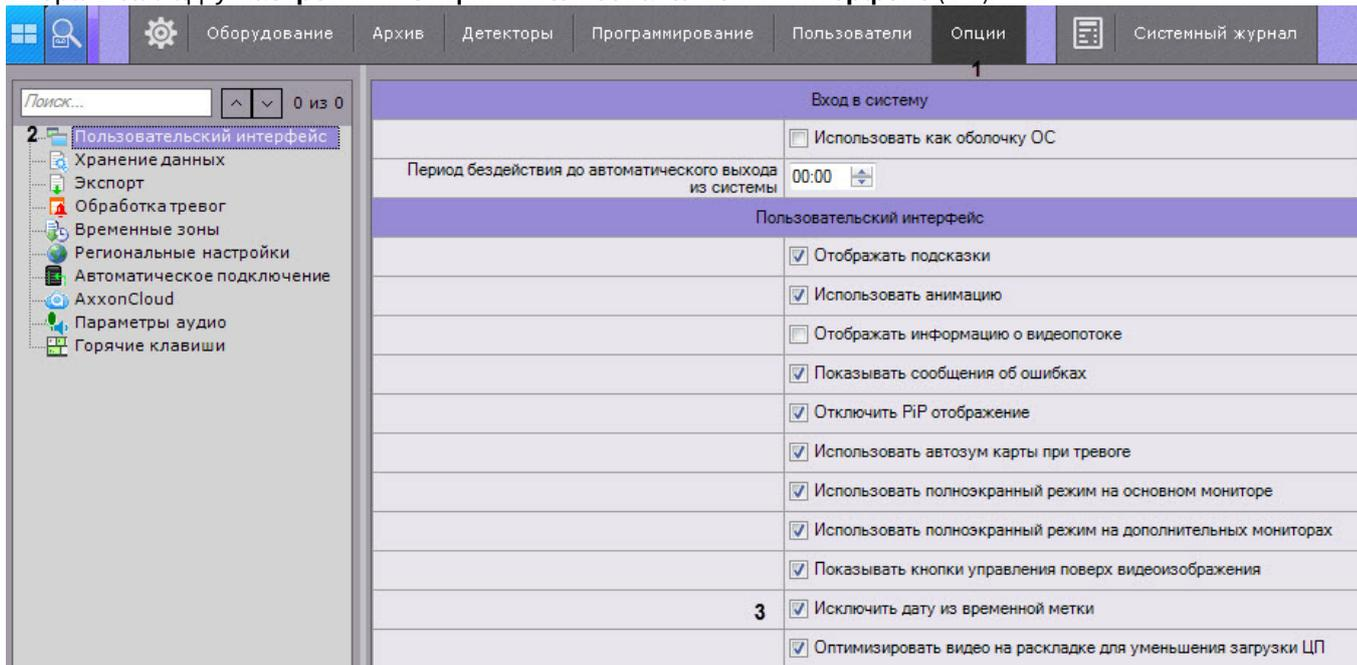
2. Снять флажок **Исключить дату из временной метки (3)**.
