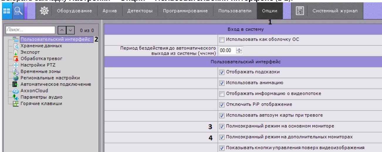
2. Для использования оконного режима на основном мониторе необходимо снять флажок **Полноэкранный режим на основном мониторе (3)**.
