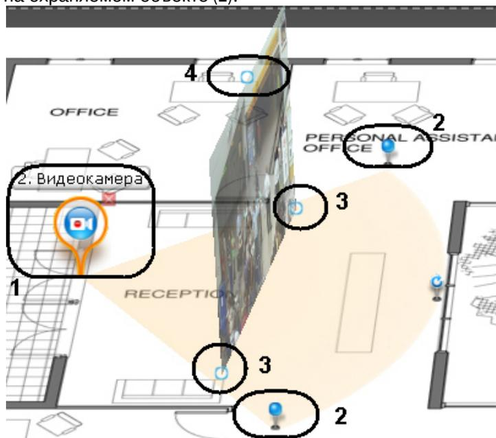
2. Изменить на карте с помощью узловых точек область поля зрения видеочамеры в соответствии с реальной ситуацией на охраняемом объекте (2).
