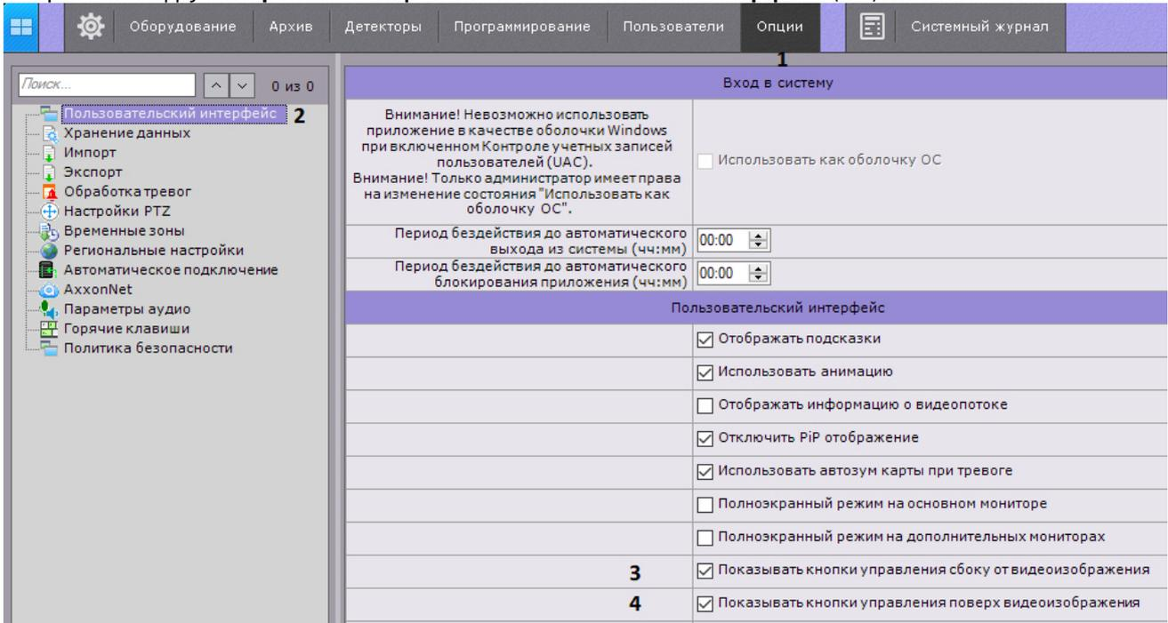
2. По умолчанию кнопки выбора режима видеонаблюдения располагаются сбоку окна видеонаблюдения. Для переноса кнопок внутрь окна необходимо снять флажок **Показывать кнопки управления сбоку от видеоизображения (3)**.
