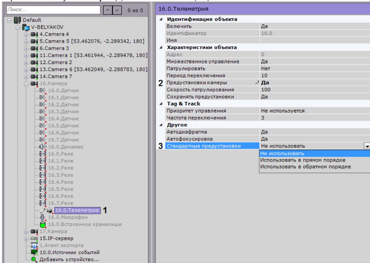
2. Установить значение **Да** для параметра **Использовать предустановки устройства (2)**.
