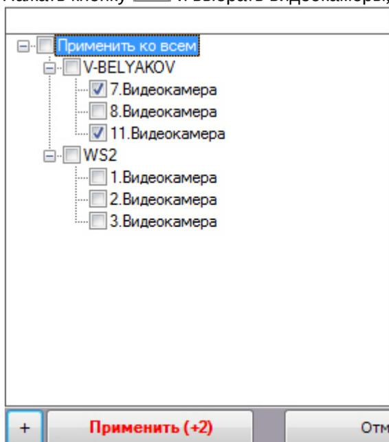
Откроется список видеокамер той же модели и прошивки в Аххон-домене. Для быстрого выбора большого количества видеокамер необходимо зажать клавишу Shift, выделить первую видеокамеру, для которой необходимо применить настройки, и последнюю. Флажок установится для всех выделенных видеокамер при выборе любой из них.
