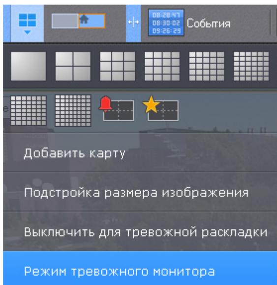
В данном режиме если нет активных тревог по видеокамерам данной раскладки на ней отображаются все видеокамеры. Если активная тревоги есть, отображаются только тревожные видеокамеры.
