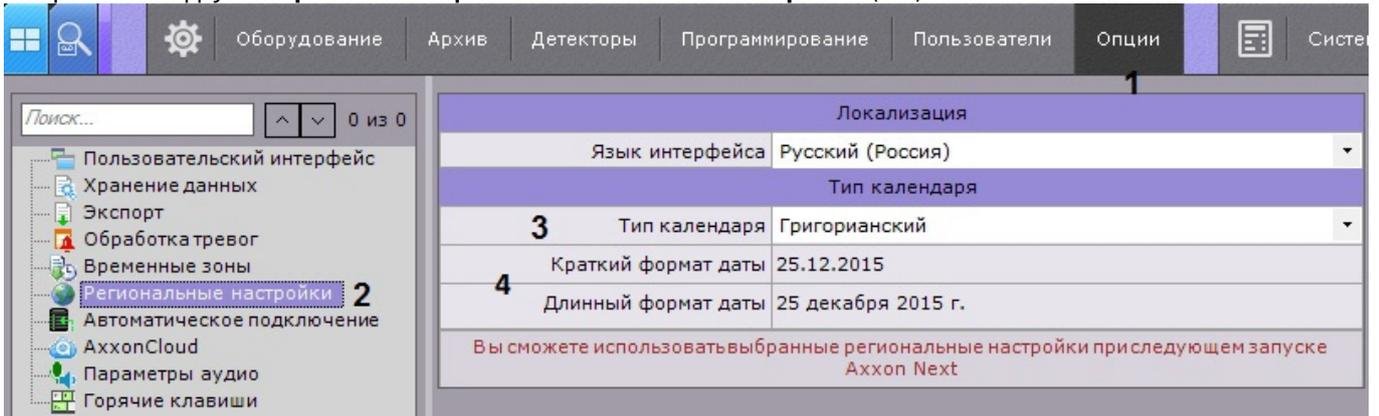
2. Выбрать тип календаря, используемого в программном комплексе *Axxon Next*, из одноименного раскрывающегося списка (3).
