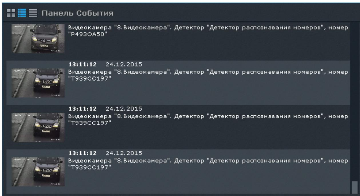
В системе существует возможность осуществлять поиск транспортных средств в архиве одной видеокамеры или в архиве нескольких видеокамер одновременно.
