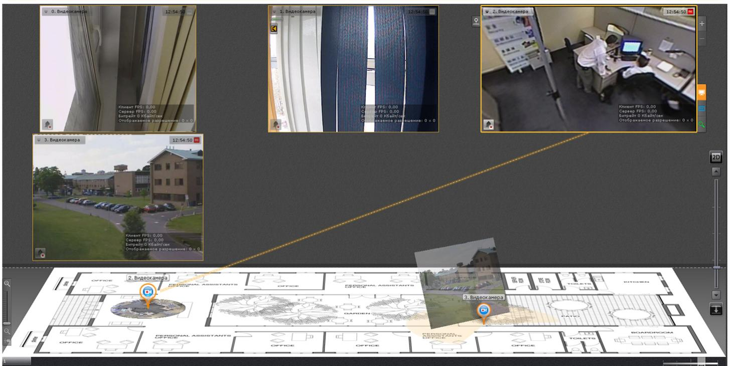
На карте могут располагаться значки видеокамер, реле и датчиков. Для каждой видеокамеры отображается сектор её обзора и область, в котором отображается видеонаблюдение в реальном времени.
