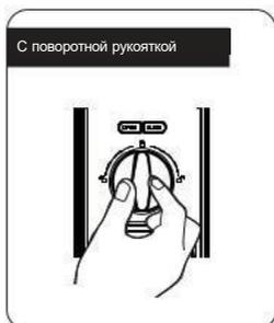
В Philips EasyKey используется внутренний врезной быстро открывающийся замок. Вы можете отпереть дверь изнутри, повернув поворотную ручку.
