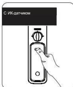
Philips Easykey оснащен инфракрасным датчиком на ручке. Когда датчик срабатывает, вы можете одновременно нажать на сенсорный модуль на передней и задней сторонах ручки, чтобы отпереть дверь.
