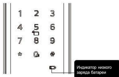
**Красный:** Когда система активна, она автоматически проверяет напряжение батареи. Если напряжение слишком низкое, индикатор будет мигать красным, прозвучит голосовая подсказка «*Низкое напряжение батареи, замените батарею*».
