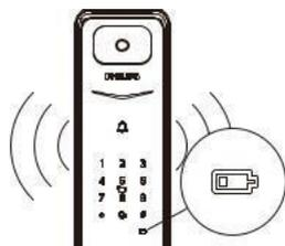
**Запуск:** Когда система активна, она автоматически проверяет напряжение батареи. Если напряжение слишком низкое, будет активировано предупреждение, чтобы напомнить вам о необходимости замены батареи.
