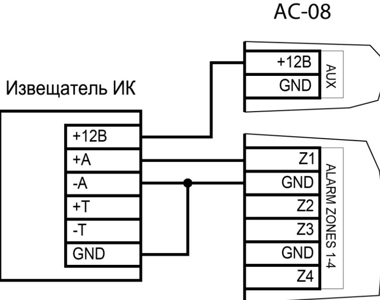
Рисунок 9. Подключение охранного датчика без контроля состояния линии
