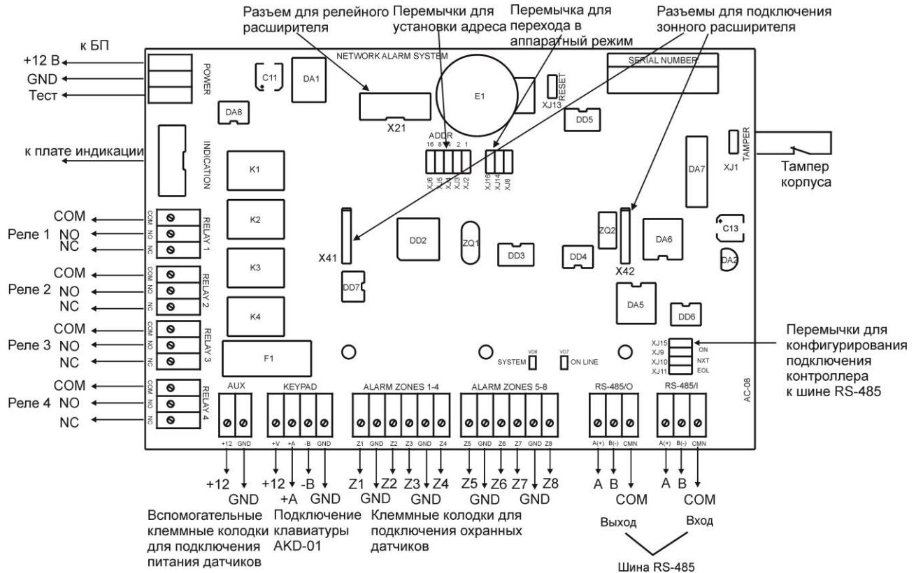
Рисунок 2. Схема платы контроллера АС-08
