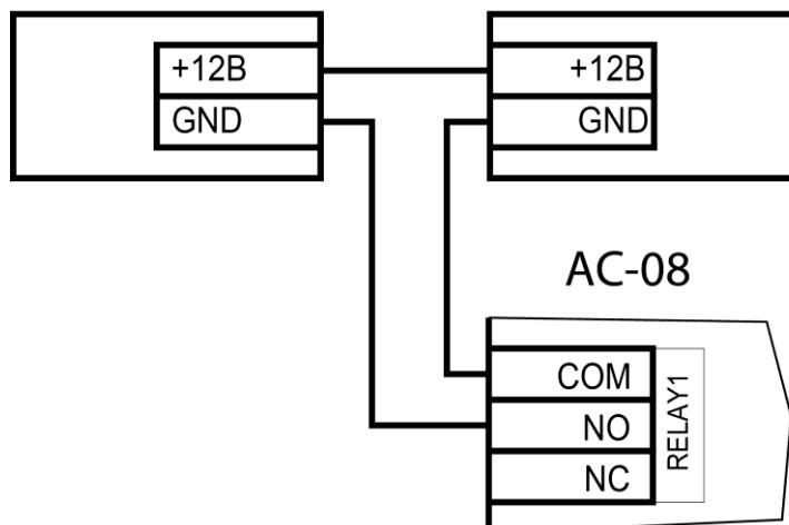
Рисунок 11. Подключение сирены к первому реле
