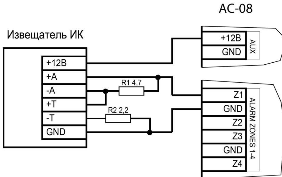
Рисунок 8. Подключение охранного датчика с контролем состояния линии
