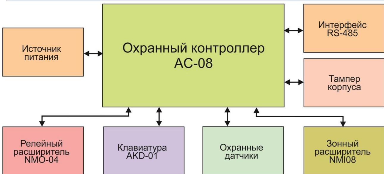
Рисунок 7. Оборудование, подключаемое к контроллеру АС-08
