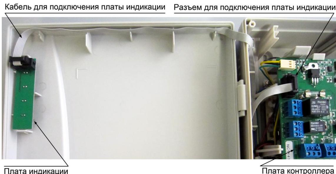
Рисунок 15. Схема подключения платы внешней индикации
