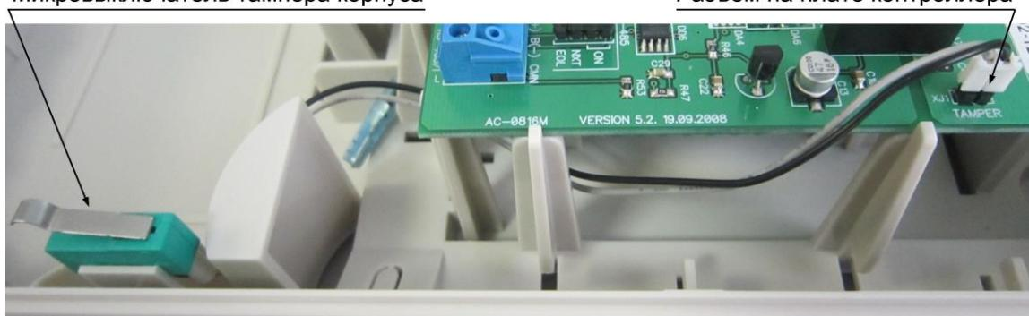
Рисунок 13. Подключение тэмпера корпуса
