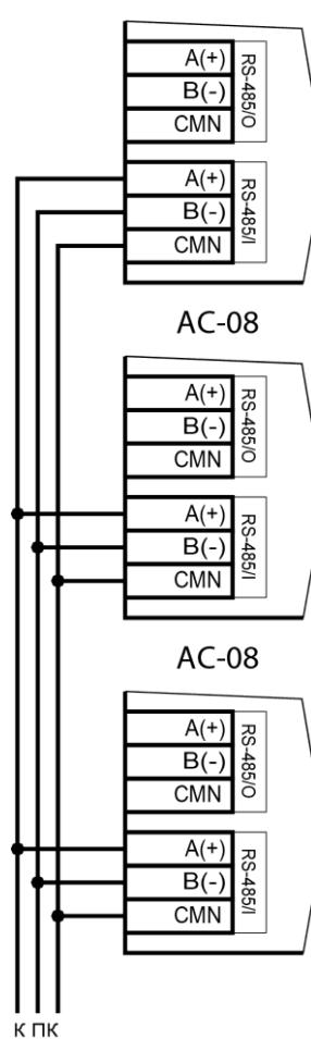
Рисунок 17. Соединение контроллеров по топологии «Звезда»
