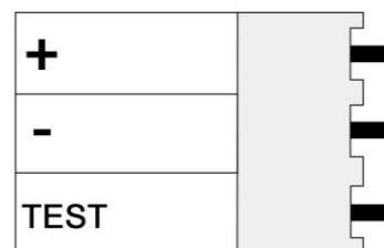
Рисунок 3. Назначение контактов разъема POWER
