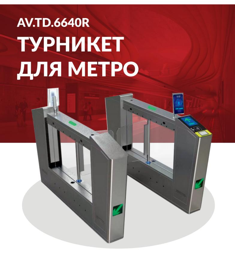
AV.TD.6640R создан специально для использования в метрополитенах. Турникет имеет рейтинг защиты IP54 и опционально комплектуется нагревателем, что делает возможным его эксплуатацию как в помещении, так и на улице в любых погодных условиях без навеса. Два типа ИК-датчиков обеспечивают корректное определение прохода, а мотор с прямым приводом - высокую скорость работы и точность позиционирования створок.
