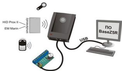
Рис. 5 Схема подключения адаптера Z-2EHR к контроллеру и компьютеру
